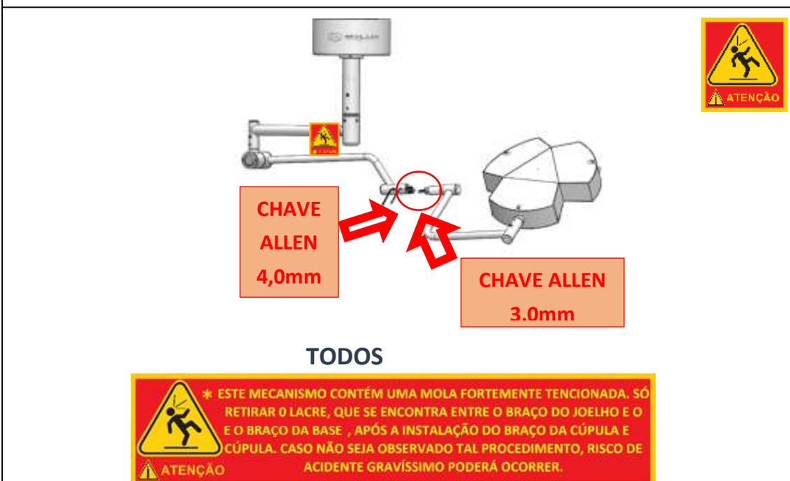
**Passo 9)** Conecte a manopla na cúpula e o foco, **RETIRA-SE O LACRE DE PROTEÇÃO** e o foco estará pronto para uso.
