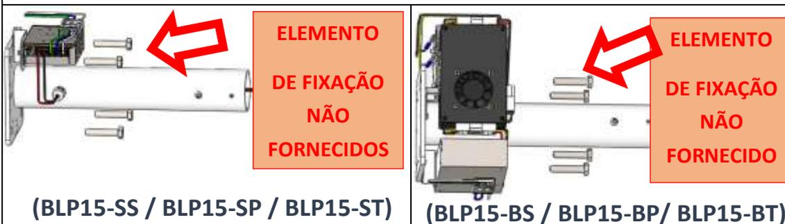
**Passo 2)** Com a base já fixada na parede, conecte a fiação em destaque à fiação da rede. Ver página 5 deste manual, nela contém o esquema elétrico de instalação. Fio Branco: Fase(L); Fio Azul: Neutro (N); Fio Verde ou Verde e Amarelo: Terra (P/PE). Nos focos que possuem bateria de emergência, conectar os conectores faston aos polos da bateria.
