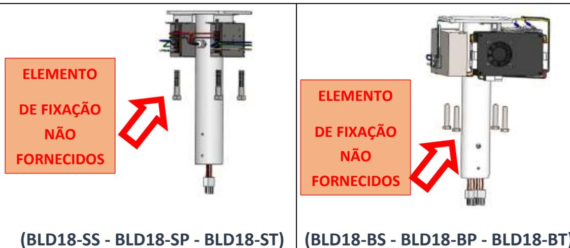
**Passo 2)** Com a base já fixada ao teto, conecte a fiação em destaque à fiação da rede. Ver página 5 deste manual, nela contém o esquema elétrico de instalação. Fio Branco: Fase(L); Fio Azul: Neutro (N); Fio Verde ou Verde e Amarelo: Terra (P/PE). Nos focos que possuem bateria de emergência, conectar os conectores faston aos polos da bateria.
